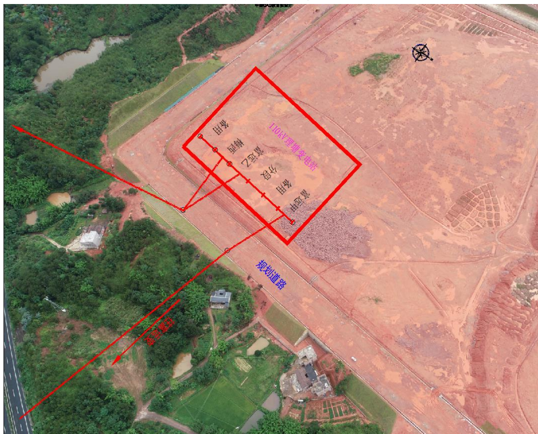
110kV 理塘站进出线平面图
